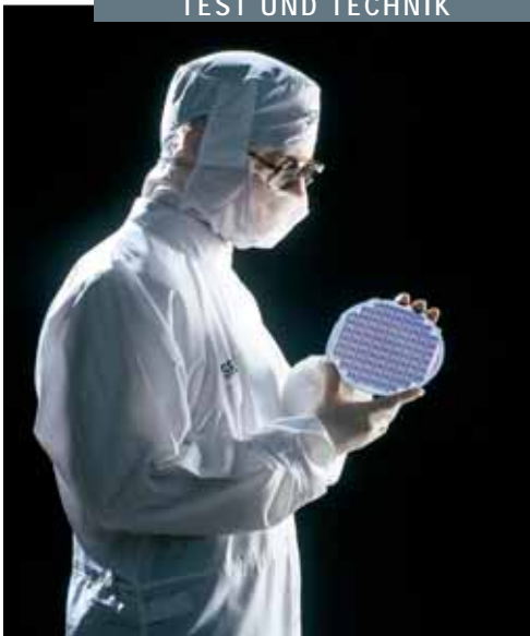
Die Herstellung von LCD-Panels und DLP-Chips erfolgt unter absolut staubfreien Bedingungen. Fotos: DLP
